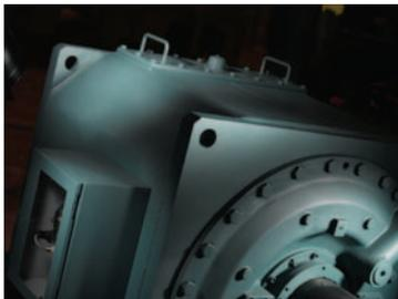
Com os acionamentos CST® da Baldor•Dodge, você obtém partidas e paradas consistentes, controladas, independentemente da variação de carga e das condições de ambiente. Em transportadores longos que empregam vários sistemas de acionamento, o CST oferece excelente compartilhamento de carga, características de limitação de torque e disponibilidade máxima de potência do motor através do perfil de velocidade controlada.
