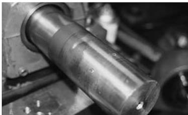
Rolamento com trava de parafuso após 500 horas
