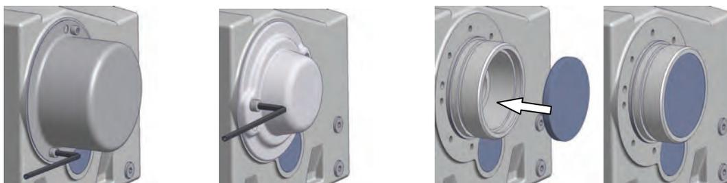
Figura 3-11: Montagem da protecção opção SH, opção H e opção H66
